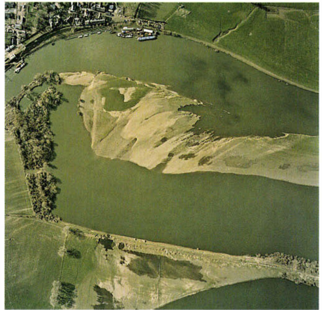
FIGUUR 3. Door het tweede hoogwater van januari 1995 vond een verdergaande erosie plaats. Osen/Linne, 9 maart 1995 (foto: Meetkundige Dienst Rijkswaterstaat).
